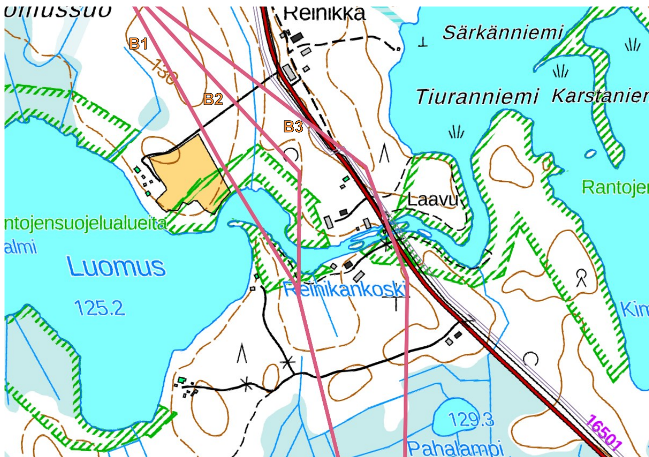
Kuva 3. Reinikankosken ylittävän sähkönsiirtoreitin (ilmakaapeli) vaihtoehdot.
